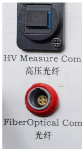
图 13 变频电源装置控制箱光纤插头
