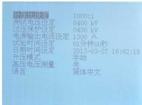
图 27 变频电源装置设定自动升压菜单
