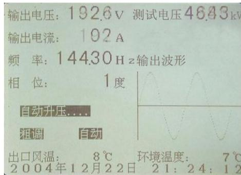
图 28 变频电源装置自动升压过程显示
