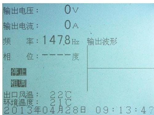
图 17 变频电源装置工作界面 1
