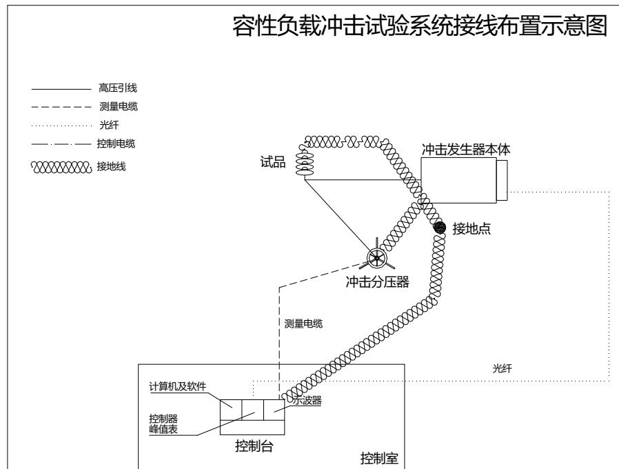
适用试品：绝缘子串、合成绝缘类产品、开关、电容器、电力电缆等
