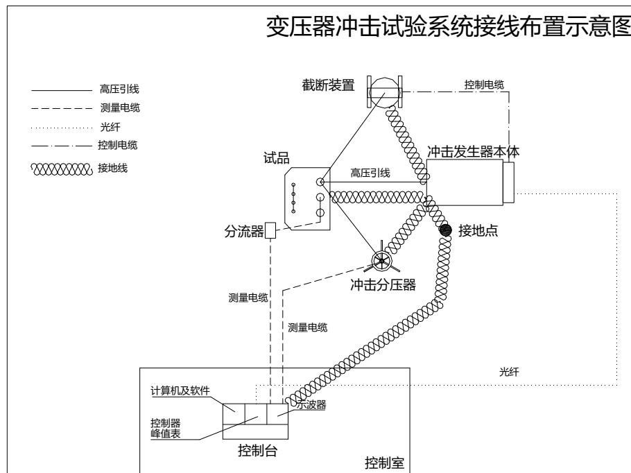
适用试品：变压器、电抗器、电压互感器
