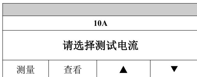
直阻仪提供了几种不同的测量电流，您可以根据需要按“▲”和“▼”键进行选择，请注意每种测量电流的最大测量范围，以免出现所测绕组直流电阻大于所选电流的最大测量范围，使测量开始后电流达不到预定值，导致直阻仪长时间处于等待状态（详细的技术参数请参见技术指标一节）。
