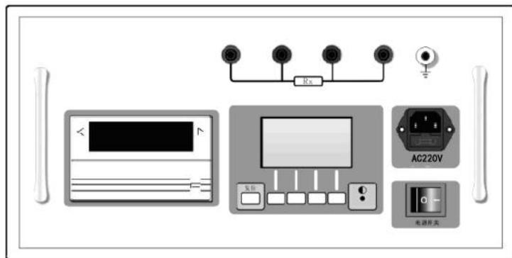
主机的面板布局如上图所示，包括打印机、液晶显示器、键盘、电源插座和电源开关以及接线端子、接地端子。
