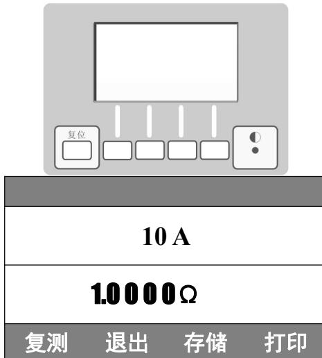
上图为液晶显示器和键盘组件组成的显示控制部分，其中显示器为点阵式液晶显示屏，用于显示操作提示、测量结果、以及指示显示屏下部 4 个多功能按键的用途。左侧的“复位”键可使仪器在出现死机或从菜单退出时直接返回到初始状态。最右侧的小孔为显示器对比度调节孔，在显示器出现显示图形对比度过深或过浅，影响阅读效果时，可以用小型“一”字改锥进行适当调节。
