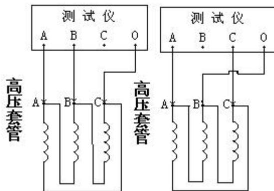
Y型接线 要分别测试 AB、BC、CA 的时候请用单相测试
