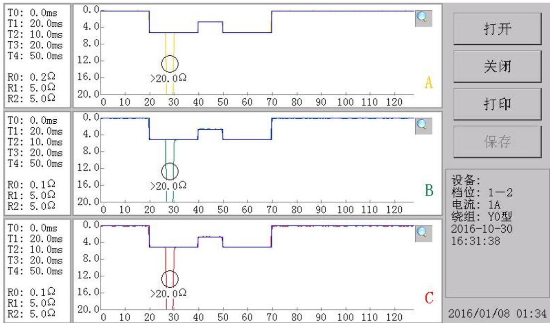
此图为变压器有载开关有断点的波形，白颜色的圆圈是提醒用户注意。
