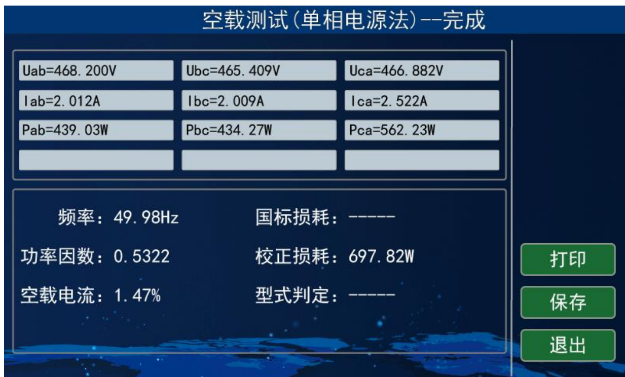
图 11-4 单相电源空载测试最终计算结果
