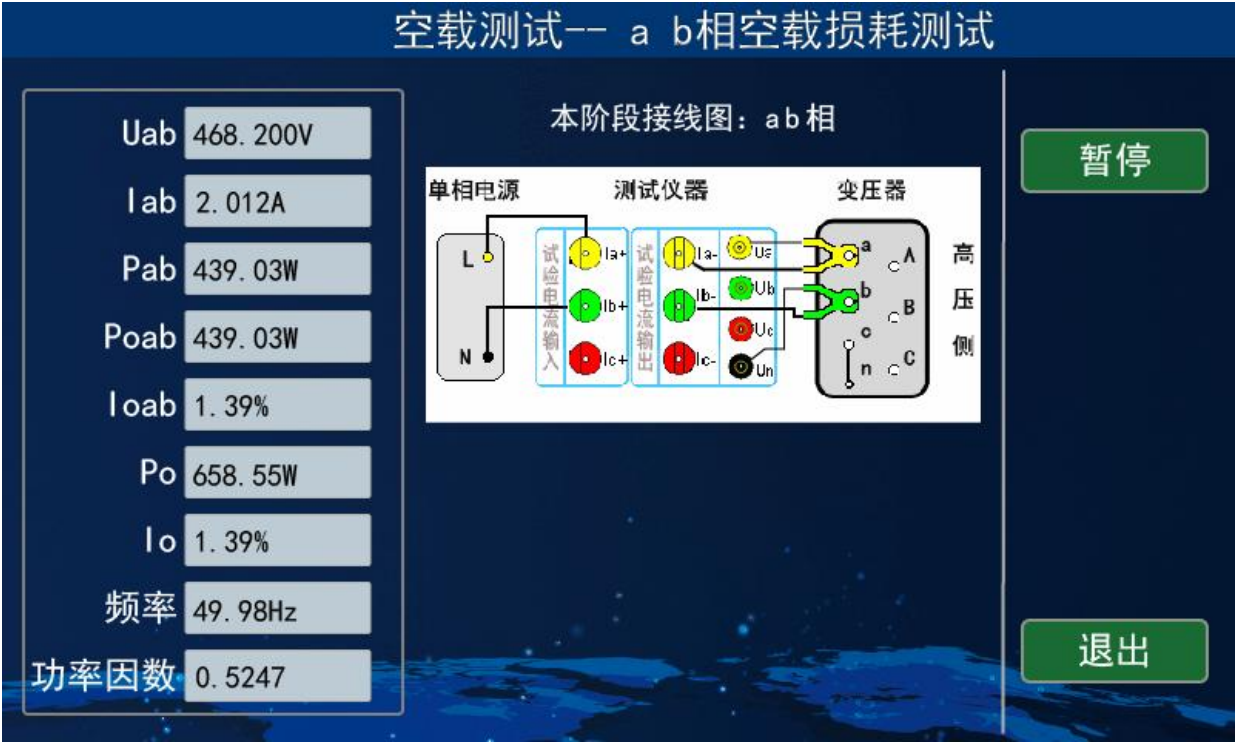
图 11-1 单相电源空载测试 AB 相
