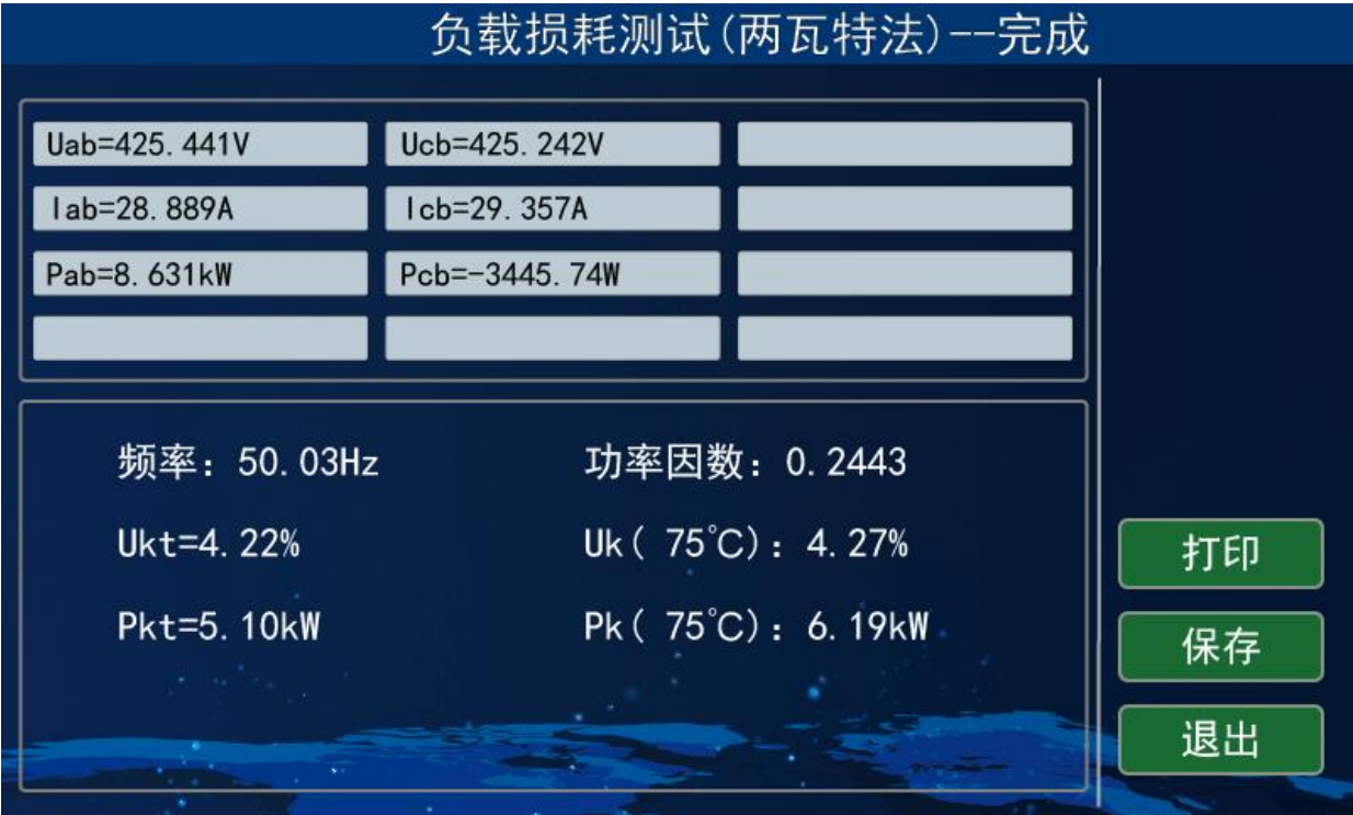
图 14-2 两瓦特法负载损耗测试结果
