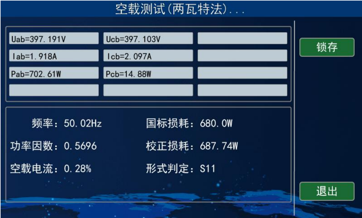
图 10-1 两瓦特法空载测试中
