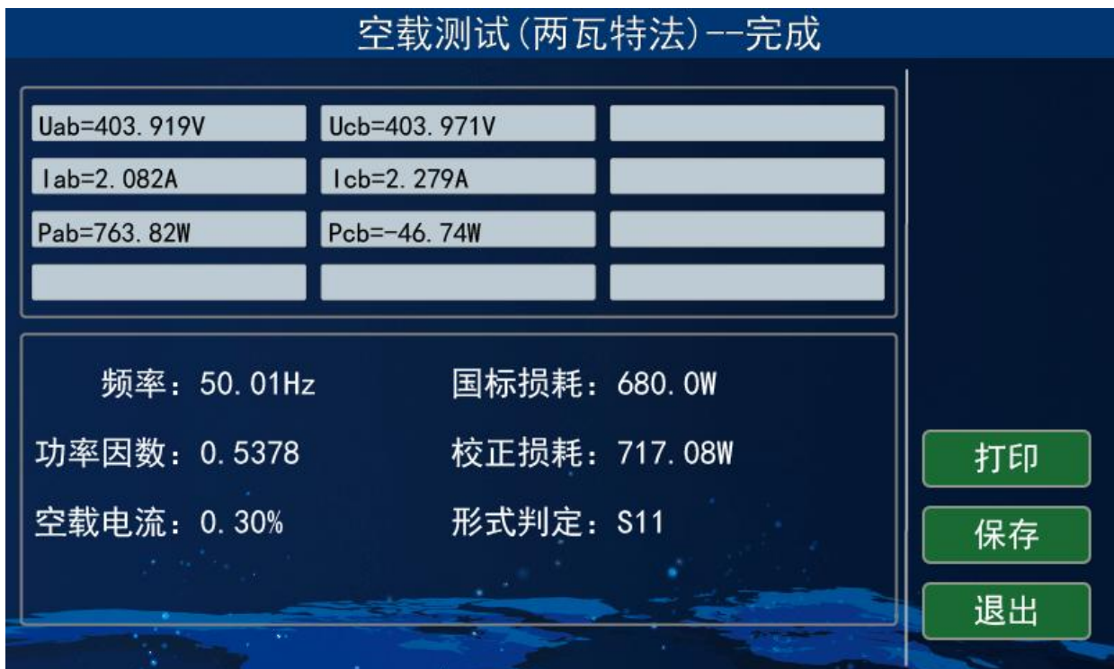
图 10-2 两瓦特法空载测试结果
