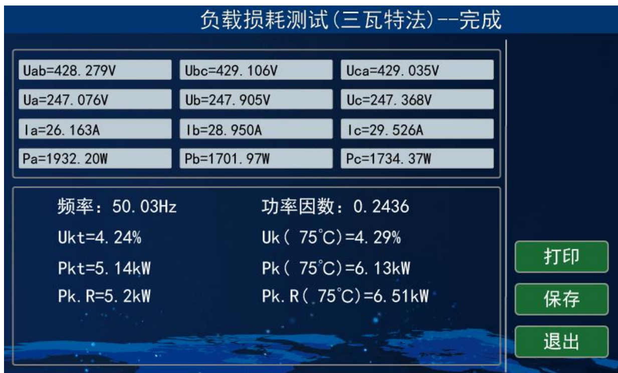
图 13-2 三瓦特法负载损耗测试结果
