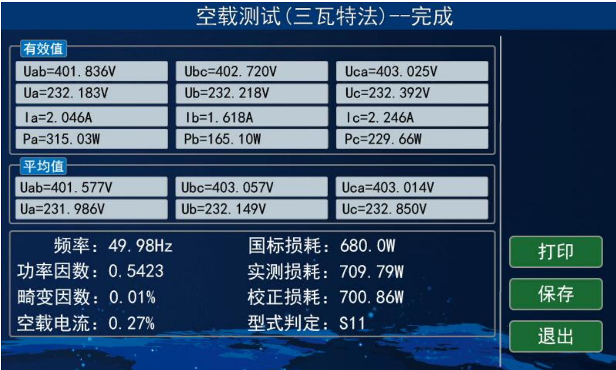
图 9-2 三瓦特法空载测试结果
