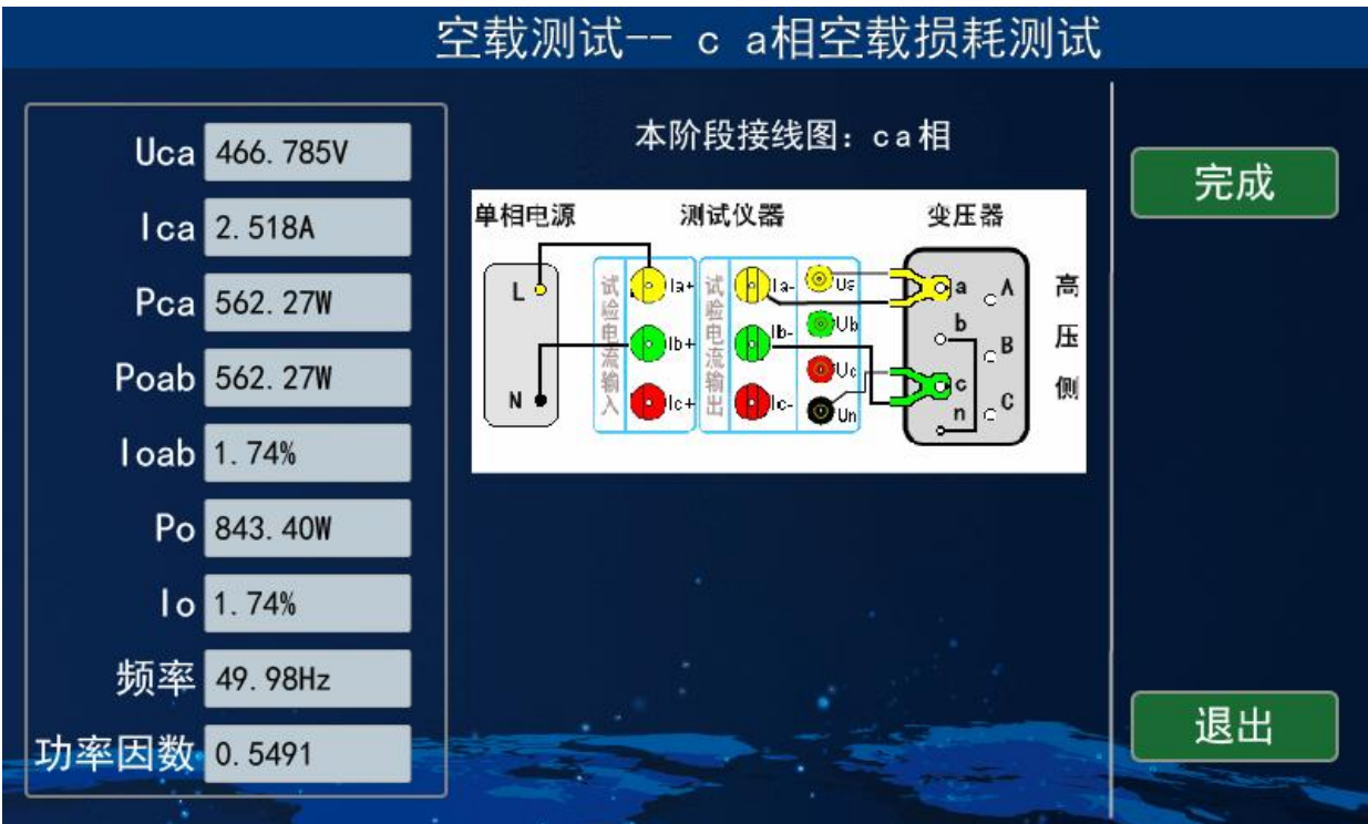
图 11-3 单相电源空载测试 CA 相
