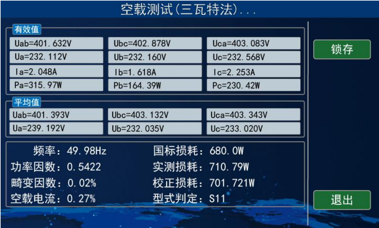
图 9-1 三瓦特法空载测试中
