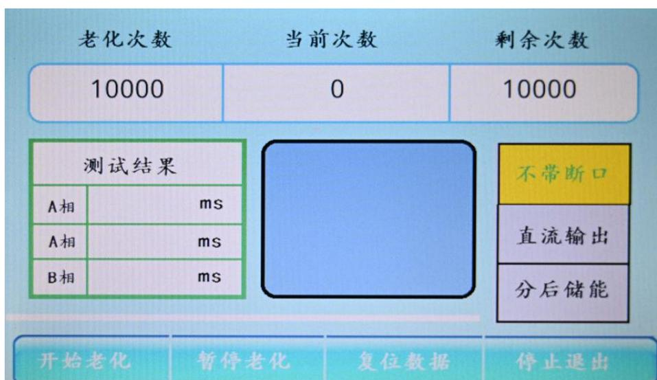
①、“不带断口”指的是不接断口直接进行老化试验，不接断口线如果发生拒合或拒分无法告警，只有接上断口线，选择“带断口”才可以声音告警提示。
