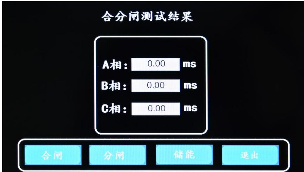
2、重合闸测试，可进行合分、分合、分合分试验测。如下图：
