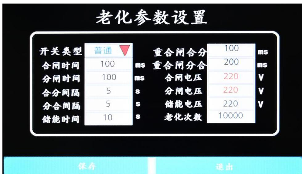
①、开关类型：有普通和接触器两种类型，凡是有合闸和分闸控制线圈的，SF6断路器、真空断路器、真空接触器（有合闸和分闸控制线圈）都选“普通”类型。只有单线圈控制的接触器，合闸有电压保持，断电分开的选“接触器”类型。
