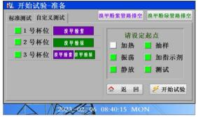
如果测试过程中使用第一种指示剂没有测试出结果,就会出现测试 失败现象,并蜂鸣器报警。使用者可以根据实际情况,决定是否更换指示 剂,更换指示剂前请将当前的测试位置的装有样品的试验杯换为空的实验 杯,然后再点击提示框右侧的确定按钮,如不需要更换指示剂,点击取消 按钮,进入下一步测试,直到试验结束,显示实验结果(下图)。
