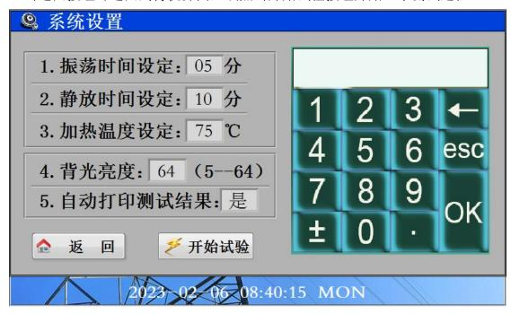
3. 开始测试 在待机界面上点击开始试验按钮首先进入的是试验准备界面, 在此界面中需要设置好参加试验模式,参与测试的杯位号。如果选择为标 准测试(下图左),则在选择好杯位号和试验的参与指示剂之后点击开始试 验按钮,即可开始一个完整的测试过程;包括有加热、振荡、静放、抽样、 加指示剂、测试等步骤。当选择自定义测试(下图右)时,可以自由设定 测试的起始点,然后开始一个不完整的测试过程。在两种测试模式中,如 果包括加指示剂这个步骤,在测试开始之前应该点击上方的两个排空按钮 对指示剂的管路进行排空操作,否则测出的结果可能是错误的。
