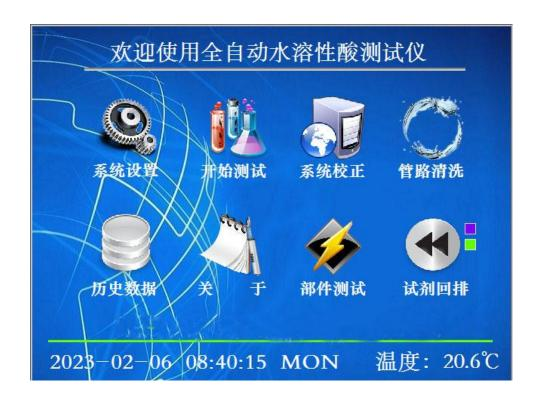
系统设置----是设置仪器振荡时间、静放时间、加热温度的参数;
