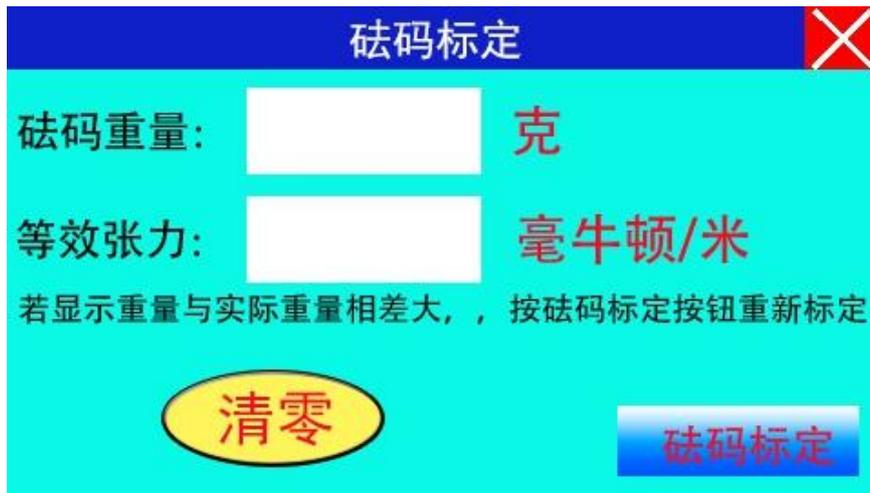
1.1 挂上铂金环和电感磁铁后，仪器“砝码重量”正常显示 0.050g 以内，如果数值偏大或低于 0g，请检查扭力丝和电感磁铁位置（是否在电感中心）。
