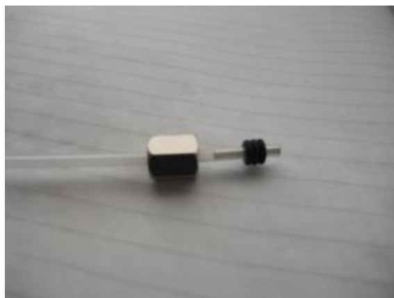
图 2.2 聚乙烯管气路连接示意图
