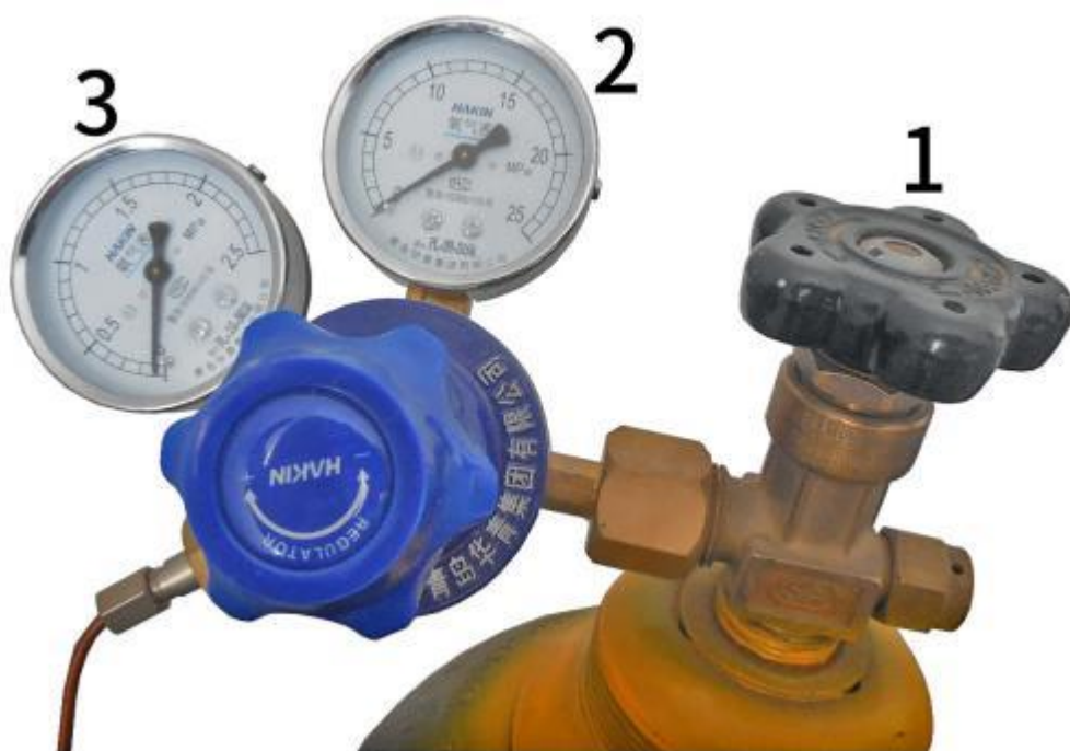
1. 总压阀 2. 总压表 3. 分压表 0.4MPa
